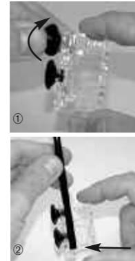
CO<sub>2</sub>-Zuleitungsschlauch mit Außendurchmesser 6 mm gerade abschneiden und in das Unterteil einlegen. Das Schlauchende muss bündig am Anschlag liegen. ②
